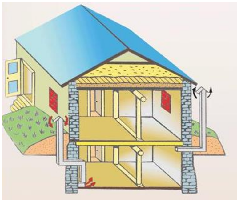
Рисунок 18. Улаштування системи вентиляції для ПРУ малої місткості
